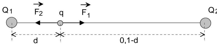
La carga  $q$  es repelida por las otras dos, cumpliéndose que los módulos de dichas fuerzas son iguales:  $F_1 = F_2$ ; al aplicar la ley de Coulomb podemos escribir:  $K \frac{Q_1 q}{d^2} = K \frac{Q_2 q}{(0,1-d)^2}$ ; si se divide todo por  $K$  y por  $q$  se llega a:  $\left(\frac{0,1-d}{d}\right)^2 = \frac{Q_2}{Q_1} = 1,5$ . Al extraer la raíz cuadrada queda:  $\frac{0,1-d}{d} = 1,22$ ;  $0,1 = 2,22d$ ;  $d = 0,045 \text{ m}$ .
