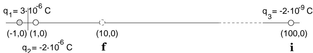
El trabajo realizado para desplazar la carga puntual  $q_3$  entre las posiciones inicial y final es igual a menos la variación de la energía potencial, esto es,  $W_{i \rightarrow f} = -\Delta E_p = q_3 \cdot \Delta V$ , ya que la energía potencial y el potencial están relacionados mediante:  $E_p = q \cdot V$ . Se calcula, entonces, el valor del potencial eléctrico, debido a las cargas  $q_1$  y  $q_2$ , en los puntos inicial y final:
