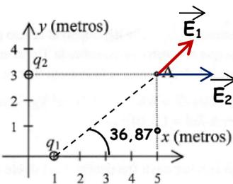
La carga 2 solo crea campo en la componente X, por lo que la componente X del campo total tiene que ser la suma de las componentes X de los campos creados por ambas cargas:
