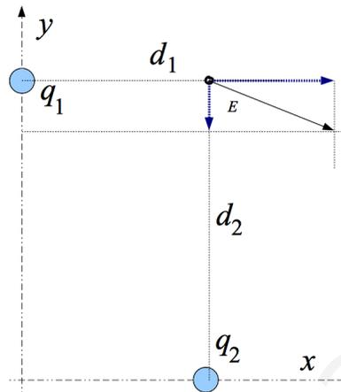
En la figura se muestra la disposición de las cargas, sus distancias al punto y una aproximación cualitativa de la fuerzas ejercidas. En su trazado, colocando una carga unidad positiva en el punto  $(3, 6)$  se ha tenido en cuenta que las cargas eléctricas del mismo signo se repelen y que las de distinto signo se atraen.
