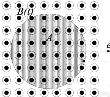
En la figura se muestra un esquema de un campo magnético atravesando el área de una espira circular. El campo debe variar en el tiempo si se quiere que circule corriente por una espira estática.
