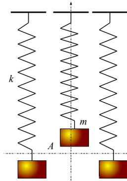
En la figura se muestra una oscilación típica de este tipo de sistemas oscilantes masa-muelle. Con el muelle extendido, o comprimido, al máximo, la energía cinética es cero y la energía elástica es máxima, igual a la energía total. Con el muelle en su longitud en ausencia de tensión, la energía cinética es máxima e igual a la energía total y la energía elástica es cero.
