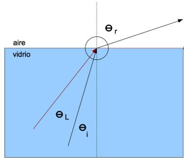
En la figura se muestra un esquema del proceso en el que un rayo de luz incide desde el interior de un vidrio sobre la superficie de separación entre éste y el aire, dando lugar a un rayo refractado. El ángulo límite es aquel en el que el rayo refractado sale perpendicular a la normal de la superficie de separación entre medios.
