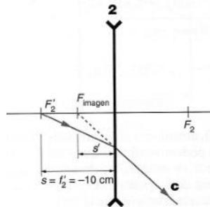
Gráficamente no se puede calcular con exactitud la posición del foco imagen, pero podemos afirmar que está entre  $F'_2$  y la lente 2.
