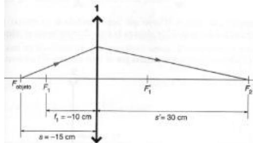
Gráficamente no podemos saber exactamente de qué punto proviene el rayo, pero podemos afirmar que está más allá del foco  $F_1$  de la lente 1, entre  $F_1$  y el infinito, ya que su imagen es real. Si el rayo viniera de un punto entre el foco y la lente, la imagen sería virtual, y se formaría a la izquierda de la lente 1.
