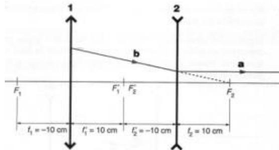
Con respecto a la lente convergente 1, el rayo hubiera llegado a cortar al eje en el punto óptico  $F_2$ , 30 cm a la derecha de la lente 1.
