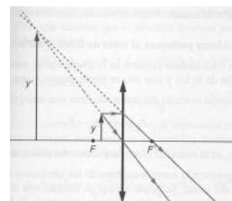
Si se sitúa un objeto perpendicular al eje óptico y a medio camino entre el foco objeto y la lente.
