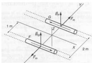
Entre ambos conductores se ejercen **fuerzas repulsivas**, como puede verse en el diagrama, debido a que las corrientes circulan en sentido contrario.
