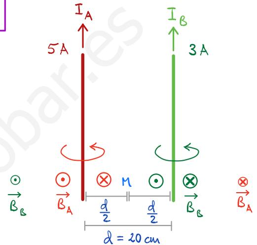
b) Como se puede apreciar en la figura, es posible que el campo se anule entre los hilos conductores porque, en esa región, tienen sentido opuesto.
