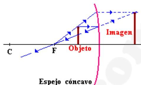
Para obtener una imagen derecha y mayor se debe colocar el objeto entre el foco y el espejo, tal y como muestra la figura del cuarto caso. La imagen que se obtiene es virtual, y aparece por detrás del espejo
