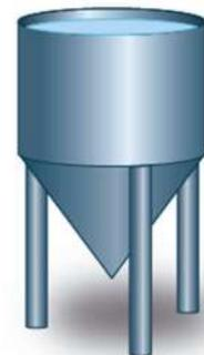
Se debe calcular el volumen de un cilindro y de un cono idénticos radios y alturas, 400 mm y 850 mm respectivamente, o lo que es lo mismo, un radio de 0,4 m y una altura de 0,85 m.
