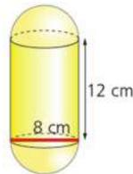
Se trata de sumar el volumen de un cilindro de 4 cm de radio y 12 cm de altura y el de dos semiesferas de 4 cm de radio (o una esfera completa de 4 cm de radio).
