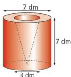
Se calcula el volumen del cilindro de 7 dm de diámetro y 7 dm de altura y se le resta el volumen de un cono de 3 dm de diámetro y 7 dm de altura.
