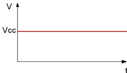
Es aquella que no cambia ni de valor ni de sentido a lo largo del tiempo, es decir, las cargas eléctricas circulan siempre en la misma dirección. La corriente continua la proporcionan los generadores como pilas, baterías y dinamos, es decir, aquellos generadores que posean polos positivos y negativo
