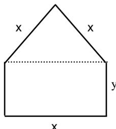
Se considera una ventana rectangular en la que el lado superior ha sido sustituido por un triángulo equilátero, como indica la figura. Sabiendo que el perímetro de la ventana es 6,6 m, hallar sus dimensiones para que su superficie sea máxima.
