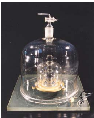
El prototipo internacional del kilogramo, \mathcal{K} , el único patrón materializado que permanece para definir una unidad básica del SI.
