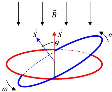
Al girar periódicamente la espira con una velocidad angular  $\omega$ , el ángulo girado será función de dicha velocidad angular, según la expresión  $\theta = \omega \cdot t$ . De este modo podemos expresar el flujo magnético en un instante dado de la siguiente forma:
