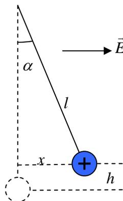
Cuando se aplica el campo eléctrico la energía potencial del sistema es de dos tipos, gravitatoria y eléctrica. Ambas varían con el ángulo  $\alpha$  (la gravitatoria crece con  $\alpha$  y la eléctrica decrece). Como el sistema está en equilibrio la energía potencial ha de ser mínima.
