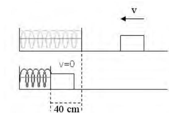
toda la energía cinética del bloque se transforma en energía potencial elástica que se acumula en el resorte, en el punto de máxima compresión ( $v = 0$ )
