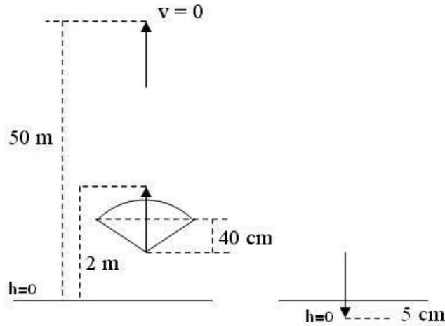
Aplicando el balance energético entre el punto inicial y el de altura máxima ( $v = 0$ ), podemos decir que la energía potencial elástica almacenada en el resorte en el momento inicial, se invierte en aumentar la energía potencial de la flecha.
