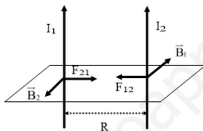
El primer conductor produce un campo magnético que envuelve al segundo conductor y viceversa.
