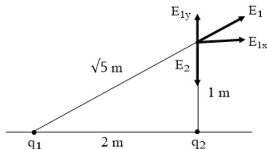
El campo eléctrico en el punto C se calcula aplicando el principio de superposición
