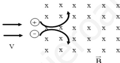
$$\left. \begin{array}{l} \text{Ley de Lorenz: } \vec{F}_m = q \cdot (\vec{v} \times \vec{B}) \\ 2^{\text{a}} \text{ Ley de Newton: } \vec{F}_m = m \cdot \vec{a} = m \cdot \vec{a}_n \end{array} \right\} \Rightarrow q \cdot v \cdot B \cdot \text{sen } 90^\circ = m \cdot a_n \Rightarrow a_n = \frac{q \cdot v \cdot B}{m}$$
