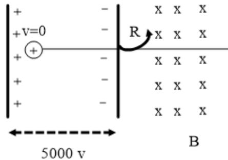
Se aplica el principio de conservación de la energía mecánica entre las placas + y -
