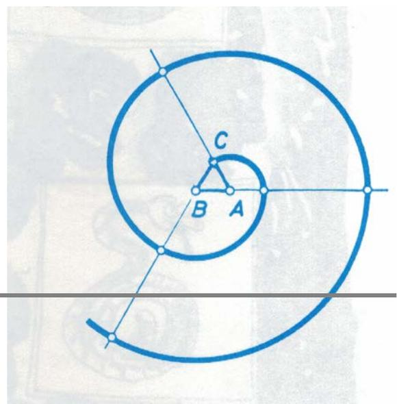
centro en C y radio triple del primero trazamos otro arco, como muestra la figura. Este proceso continua indefinidamente alternando los centros A y B.
