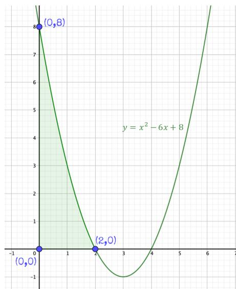
Como se ve en el dibujo, el área queda determinada por la parábola, por el eje OX ( $y = 0$ ) y por el eje OY ( $x = 0$ ). Planteamos el cálculo del área sombreada:
