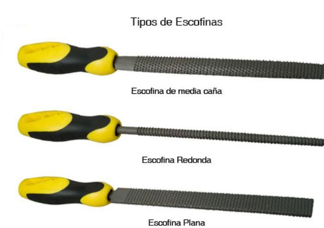
Las **ESCOFINAS** poseen resaltes en forma de granitos o dientes triangulares más o menos separados. Sirven para arrancar pequeñas astillas de madera. Los cortes que realizan pueden ser gruesos, medios o finos.
