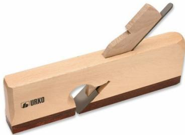
Se aplica para rebajar la madera mediante la extracción de tiras de fino espesor. Consta principalmente de un cuerpo de madera en forma de prisma con una abertura transversal más o menos inclinada donde se coloca una cuchilla de acero sujeta por una cuña.
