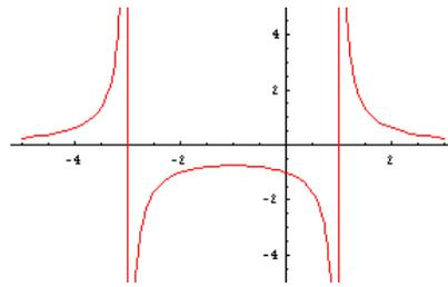
De la figura se observa que  $f(-2) = -1$ , y que las rectas  $x = -3$  y  $x = 1$  son asíntotas verticales. De  $f(-2) = -1$ , obtenemos:
