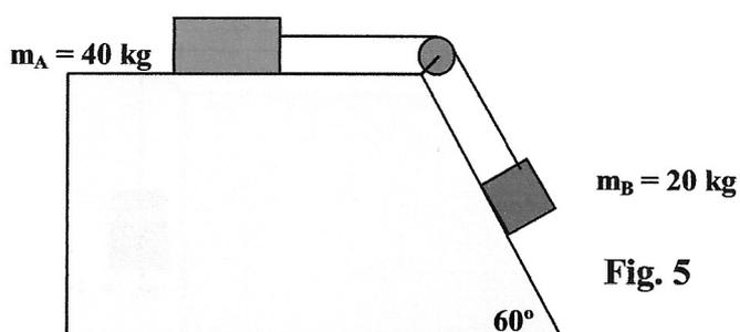
Calcula: a) La velocidad del cuerpo B a los 22 s; b) La tensión que soporta el cable. Dato  $\mu = 0,3$ .
