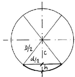
22. **NUEVO 2012/13** En un determinado ensayo de dureza Brinell se aplica una carga de 1600 Kp a un penetrador de diámetro 8 mm obteniéndose una huella de 3,15 mm de diámetro.
