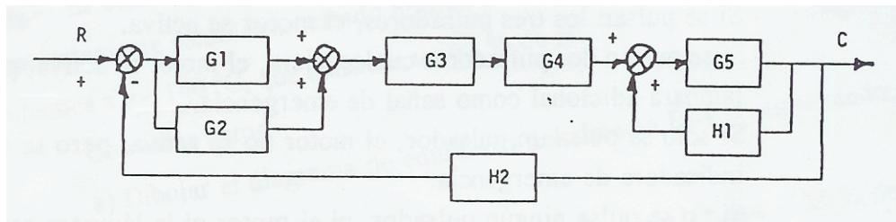
7.- Simplifica el siguiente diagrama de bloque de la figura, representando el diagrama simplificado de la función de transferencia total del sistema.
