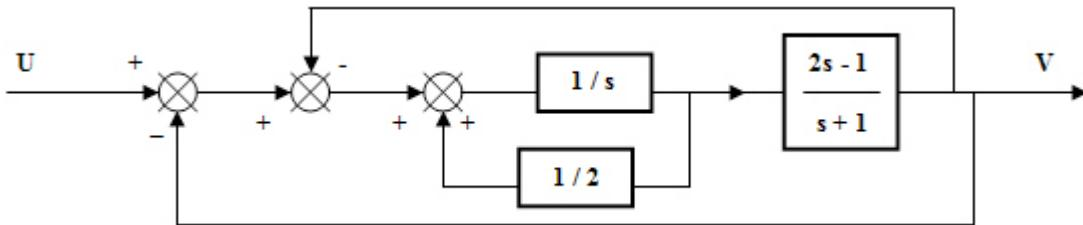
3.- Halla la función de transferencia del sistema representado mediante el siguiente diagrama de bloques.
