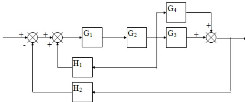
8.- Simplifica el siguiente diagrama de bloque de la figura, representando el diagrama simplificado de la función de transferencia total del sistema.
