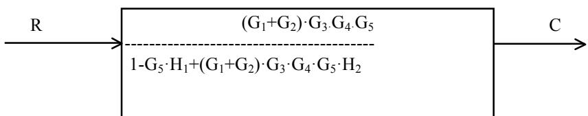
7.- Simplifica el siguiente diagrama de bloques de la figura, representando el diagrama simplificado de la función de transferencia total del sistema
