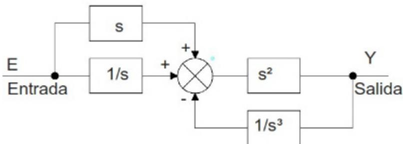
12.- **NUEVO 2011/12** Dado el diagrama de bloques de la figura obtenga la función de transferencia Z/Y.
