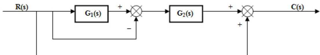
5.- Reducir el diagrama de bloques de la figura y obtener la función de transferencia  $C(s) / R(s)$ .
