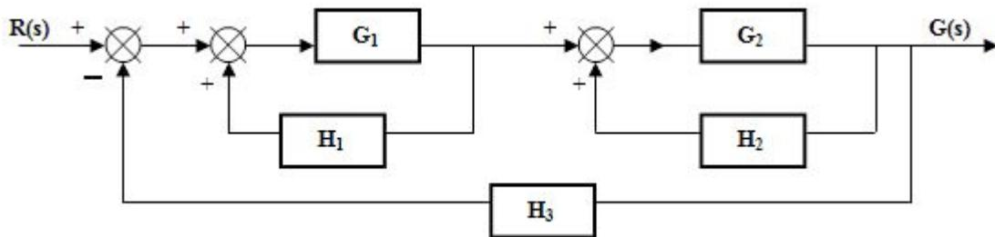
4.- Simplificar el siguiente sistema de control hasta conseguir la función de transferencia.
