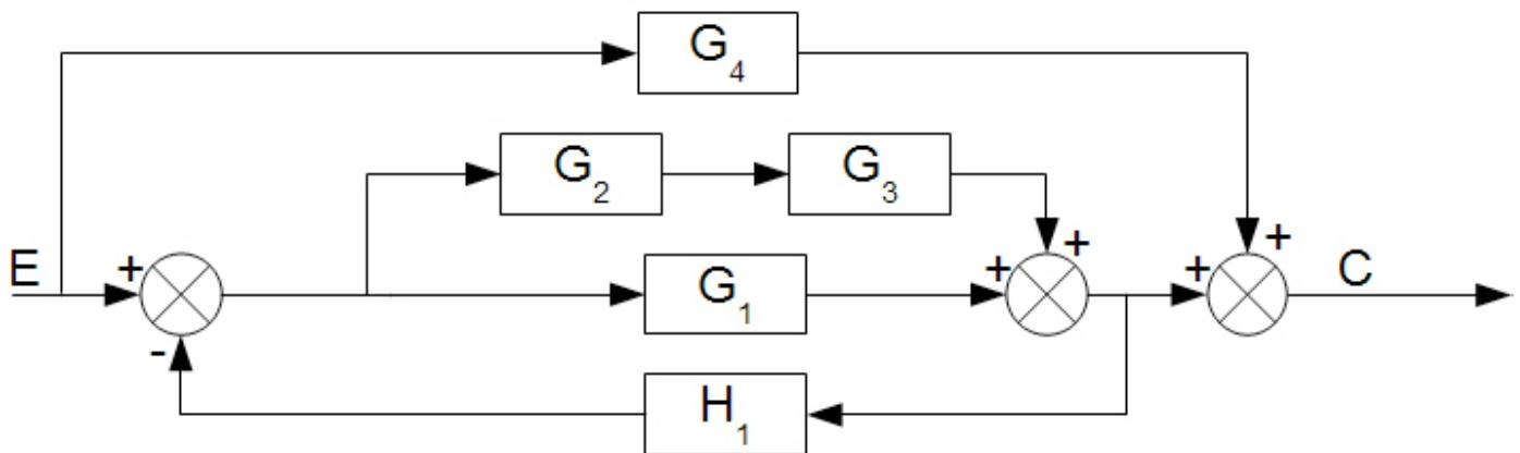
18.- **NUEVO 2012/13** Determinar la función de transferencia total del sistema caracterizado por el diagrama de bloques.
