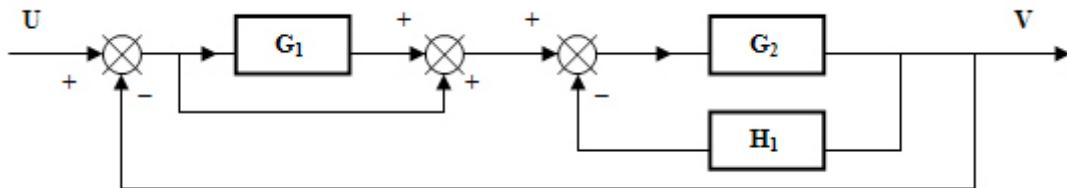
2.- Simplificar el siguiente sistema de control hasta conseguir la función de transferencia.
