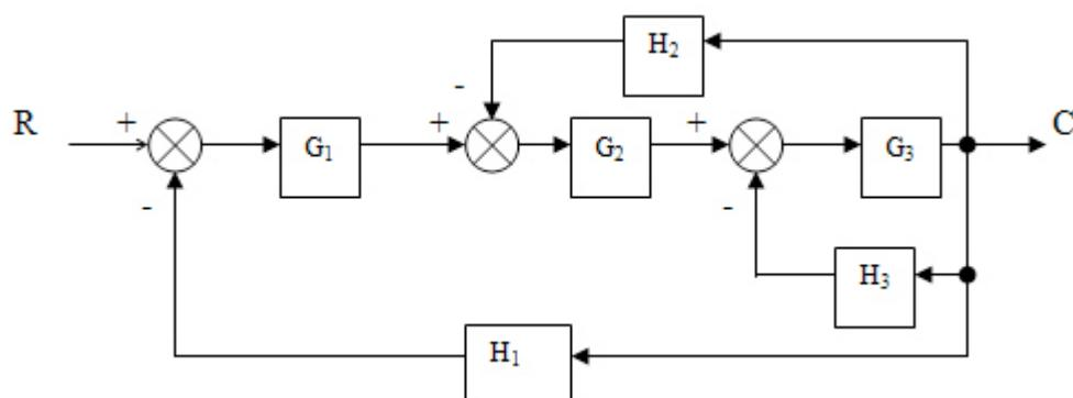
10.- Simplifica el siguiente sistema de control hasta conseguir la función de transferencia del sistema.
