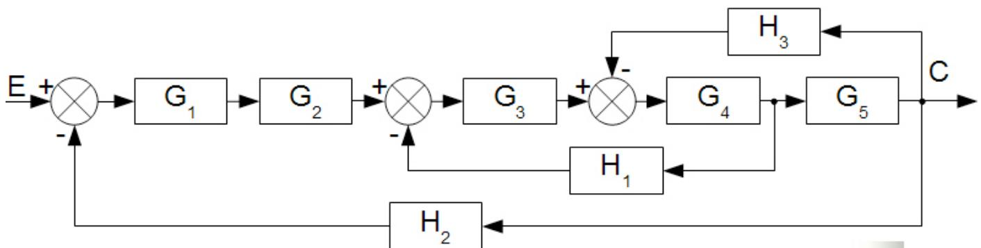
1.- Halla la función de transferencia del sistema representado mediante el siguiente diagrama de bloques.
