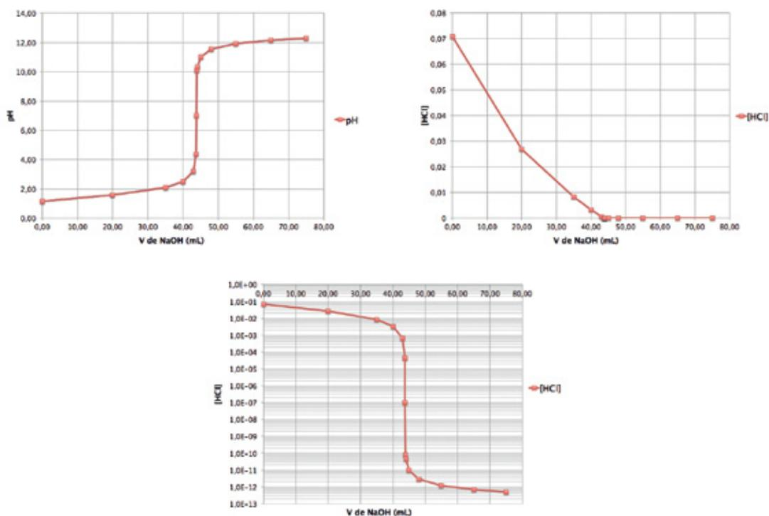
El volumen de valorante en el punto de equivalencia se obtiene realizando los cálculos estequiométricos correspondientes a esta reacción, con estos datos:
