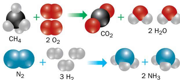
En el primer cambio químico, se rompen cuatro enlaces C-H y dos enlaces O-O; se forman dos enlaces C-O y cuatro enlaces O-H.
