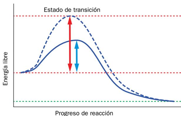
La reacción catalizada es la que se representa en línea continua, pues es la que tiene menor energía de activación. Se trata de una reacción exotérmica, pues la energía de los productos es menor que la de los reactivos.
