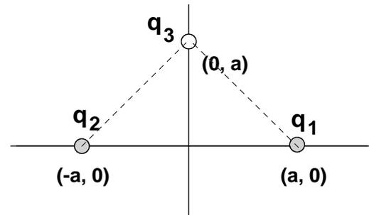
$$\text{En consecuencia, } U_{\text{sistema}} = U_{12} + U_{13} + U_{23} = k\frac{q_1q_2}{2a} + k\frac{q_1q_3}{\sqrt{2}a} + k\frac{q_2q_3}{\sqrt{2}a}.$$
