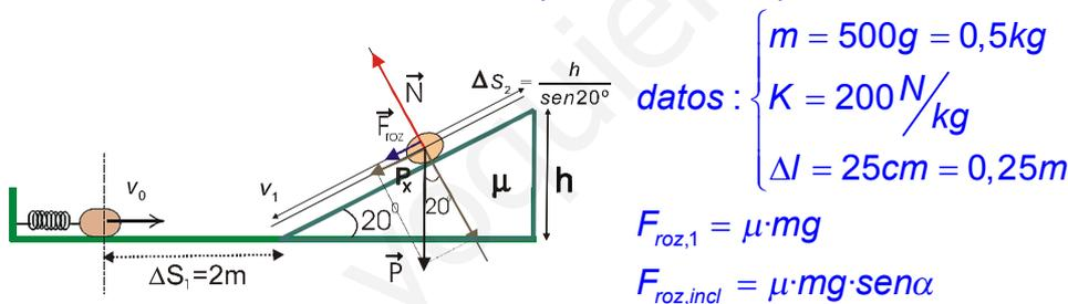
$$\text{datos: } \begin{cases} m = 500g = 0,5 \text{ kg} \\ K = 200 \text{ N/kg} \\ \Delta l = 25 \text{ cm} = 0,25 \text{ m} \end{cases}$$
