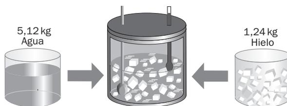
El agua y el hielo contenidos en el calorímetro están a 0°C. De los 900 g de vapor de agua, el hielo absorbe energía para fundirse:
