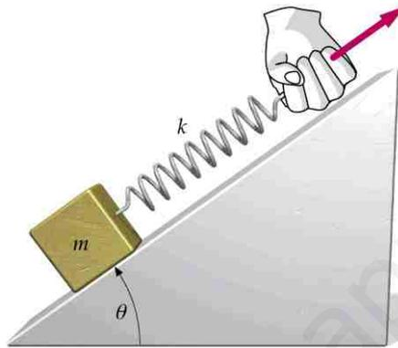
a) Cuando el muelle se haya estirado una distancia  $d$ , el movimiento será inminente. Entonces la fuerza del muelle será compensada por la componente del peso del cuerpo a lo largo del plano y la fuerza de rozamiento estática:
