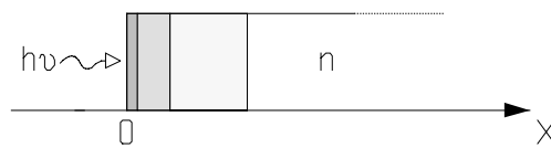
Fig. 6.9 Inyección lateral en estado estacionario
