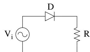
Figura 10: Rectificador de media onda positivo
