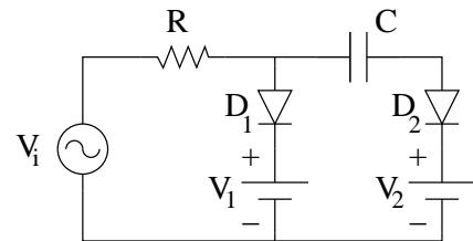
Figura 9: Fijador de nivel
