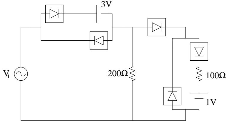
Figura 2: Circuito resultante de sustituir los diodos de la figura 1 por sus equivalentes por tramos lineales y cada elemento por su valor.
