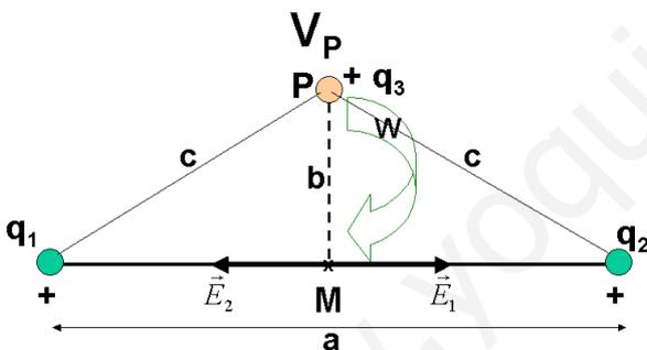
$$\vec{E}_M = \vec{E}_1 + \vec{E}_2 = (E_1 \vec{i}) + (-E_2 \vec{i}) = (E_1 - E_2) \vec{i} = 0 \text{ N/C}$$
