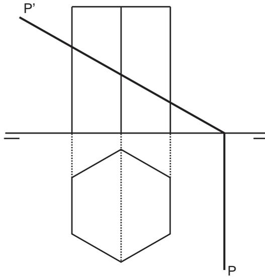
Dada la pirámide recta de base hexagonal y el plano P determina las proyecciones de la sección y su verdadera magnitud y forma.
