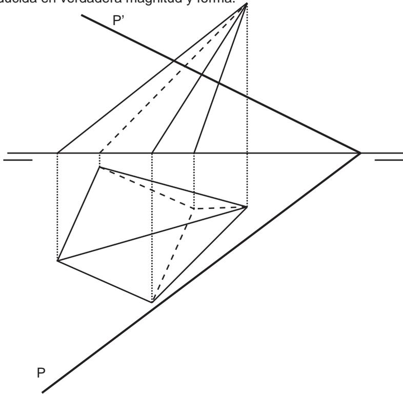
Dadas las proyecciones del prisma recto de base pentagonal y el plano P, determina las proyecciones de la sección producida y abátela sobre el PV de proyección.
