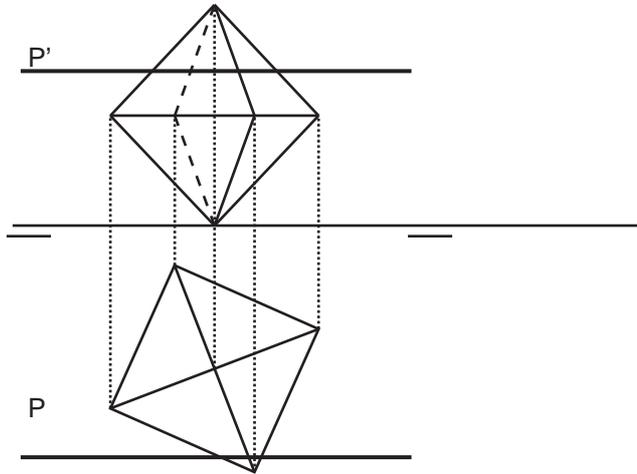
Dadas las proyecciones del prisma oblicuo de base cuadrada y el plano P paralelo a la línea de tierra determinar la sección plana en verdadera magnitud y forma que el plano produce con el prisma.
