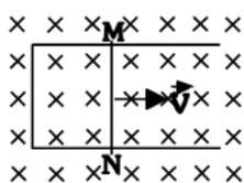
13.- Una espira rectangular está formada por un lado móvil MN que se mueve como se indica en el dibujo con  $v=1 \text{ m/s}$ . Dicha espira sufre un campo magnético perpendicular a ella  $B = 5 \text{ T}$ .
