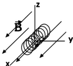
12.- Una bobina de 10 espiras, de 2 cm<sup>2</sup> cada una, gira a 100 rpm alrededor del eje OZ, en presencia de un campo magnético uniforme de 0,2 T dirigido en el sentido positivo del eje OX.
