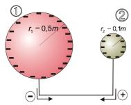
Al conectar las esferas fluirán cargas negativas desde la esfera cargada a la esfera neutra. La situación de equilibrio se producirá cuando los potenciales de ambas esferas se igualen. En ese momento los potenciales serán:  $V_1' = V_2'$ . Las dos esferas, al final, tendrán carga negativa y potenciales negativos.
