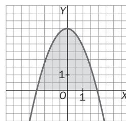
Veámoslo: Área =  $2 \int_0^{\sqrt{\frac{c}{a}}} (-ax^2 + c) dx = 2 \left[ -a \frac{x^3}{3} + cx \right]_0^{\sqrt{\frac{c}{a}}} = \frac{-2a}{3} \frac{c}{a} \sqrt{\frac{c}{a}} + 2c \sqrt{\frac{c}{a}} = \sqrt{\frac{c}{a}} \cdot c \left( -\frac{2}{3} + 2 \right) = \frac{4}{3} c \sqrt{\frac{c}{a}}$ , como queríamos probar.
