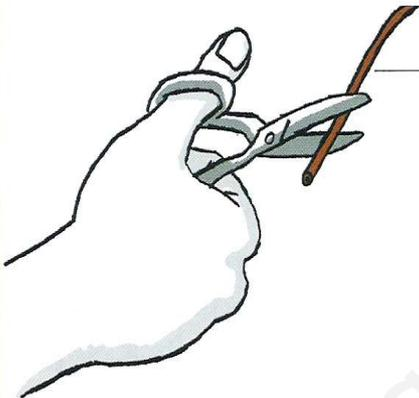
De forma «casera»: se pueden usar unas **tijeras** para cortar el plástico con cuidado (sin dañar los hilos de cobre).
