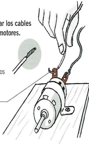
Las pestañas se rompen con facilidad. Para evitarlo, puedes doblar los cables y sujetarlos con cinta aislante sobre el motor.
