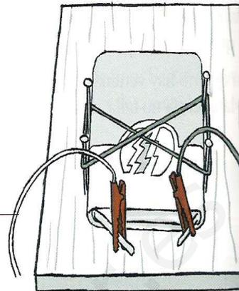
De forma «profesional»: sujeta los cables con pinzas de cocodrilo y la pila a la base con **clavos y gomas**.
