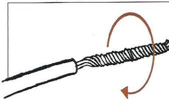
En la unión entre los cables se enrolla la cinta aislante.
