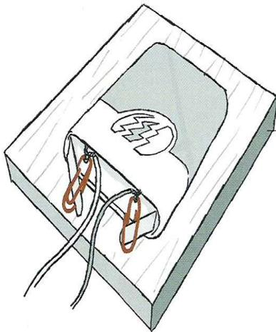
De forma «casera»: pela los cables, enróllalos a los clips y ponlos en los polos. Pega la pila a la base con **termo-fusible**. Usa poca cantidad para poder cambiar la pila cuando se agote.
