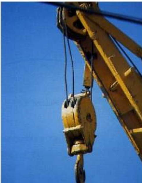
Las grúas y puentes-grúa utilizan polipastos gracias a los cuales el motor recoge el cable rápidamente para subir pesadas cargas lentamente y con poco esfuerzo. (foto)
