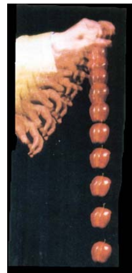
Fotografía estroboscópica obtenida a 60 imágenes por segundo.
