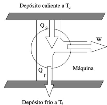
Los rendimientos de las máquinas térmicas tienen valores del orden del 40 %, mientras que los motores de combustión interna pueden alcanzar valores próximos al 50 %. Es imposible construir una máquina térmica con un rendimiento del 100 %, ya que esto significaría que todo el calor absorbido del foco caliente se convertiría en trabajo y el foco frío no recibiría ninguna cantidad de calor.
