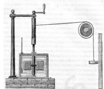
Con este experimento pudo determinar que el trabajo necesario para elevar la temperatura de 1 g de agua en 1 °C es de 4,184 J. Este resultado según el cual 4,184 J de energía mecánica es equivalente a 1 cal de energía térmica se conoce con el nombre de equivalente mecánico del calor.
