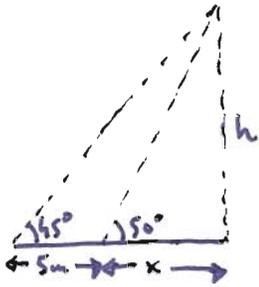
$$\begin{aligned} \text{triángulo pequeño: } \tan 50^\circ &= \frac{h}{x} \rightarrow h = x \cdot \tan 50^\circ \quad (1) \\ \text{triángulo grande: } \tan 45^\circ &= \frac{h}{x+5} \rightarrow h = (x+5) \cdot \tan 45^\circ \quad (2) \end{aligned}$$
