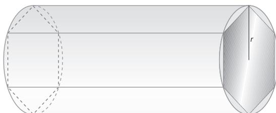
El resultado es un prisma metálico, de base un hexágono regular, inscrito en un cilindro de material aislante.
