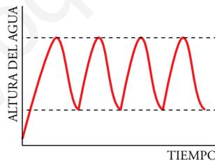
Puesto que cuando el tanque se llena hasta arriba el tubo también se llena y empieza a salir el agua del tanque. Esto ocurre hasta que el nivel del agua alcanza la entrada del tubo (efecto sifón). En ese momento deja de salirse agua y comienza a llenarse de nuevo el tanque.
