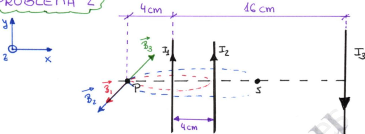
Con la regla de la mano derecha, hemos determinado la dirección y el sentido de los vectores  $\vec{B}_1$  y  $\vec{B}_2$  según:
