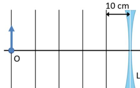
En la figura se muestra una lente,  $L$ , y la posición de un objeto,  $O$ . La imagen es virtual y se encuentra a 10 cm de la lente. Determina la distancia focal imagen de la lente, la potencia de la lente en dioptrías y el tamaño de la imagen si el objeto mide 5 cm.
