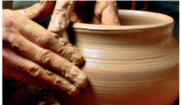
Un material plástico queda permanentemente deformado al cesar la fuerza aplicada sobre él.
