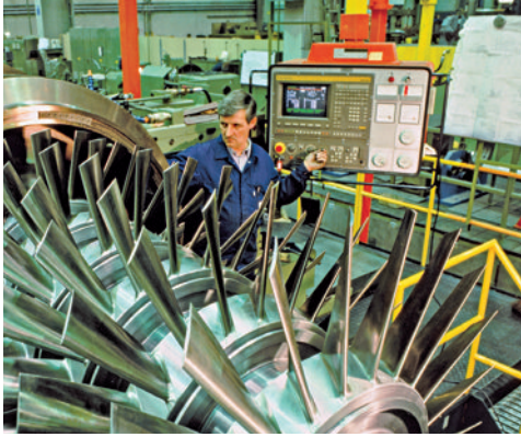
Turbina de vapor. Esta turbina gira cuando la impulsa un chorro de vapor a presión.
