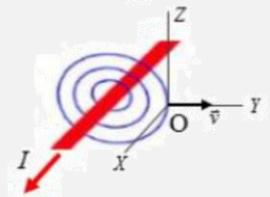
Según la regla de la mano derecha, cuando un conductor transporta la corriente tal y como se indica en la figura, el sentido del campo magnético es antihorario visto desde la parte anterior.
