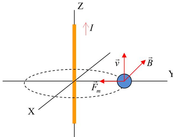
calculamos primero el campo magnético creado por el conductor a los 5 cm de distancia
