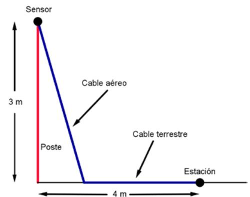
Llamamos  $a$  a la longitud del cable aéreo y  $b$  a la longitud entre la base del poste y el punto donde comienza el cable terrestre, por tanto el cable terrestre medirá  $4 - b$ .
