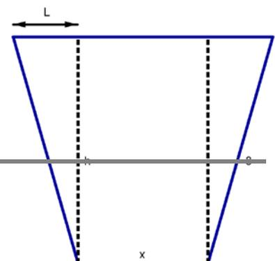
a) Encuentra el valor del segmento L del dibujo en función de la variable x (anchura inferior del canal) y teniendo en cuenta el área de un trapecio, comprueba que, en este caso, el área de la sección viene dada por:
