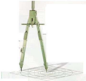
Otra herramienta para el dibujo es el **compás**. El compás tiene dos brazos: un brazo acaba en aguja metálica y en el otro una mina. Con el compás podemos **trazar círculos** y, además podemos **tomar medidas**. Para trazar círculos con el compás debemos seguir los pasos que aparecen en esta imagen.
