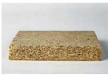
Se fabrica mezclando virutas de madera con cola. La mezcla se prensa y obtenemos un tablero del grosor deseado. Es una madera bastante barata y fácil de trabajar. Normalmente esta madera está forrada por las dos caras con plástico o una chapa fina de madera pues es sensible a la humedad. Además, su textura (tacto) es porosa y tiene mal acabado. Usos: muebles, piezas de módulos de cocina, armarios, ...
